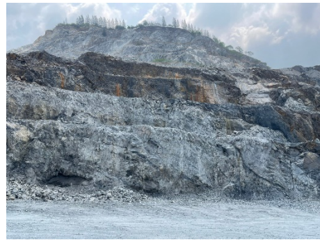
รูปที่ 2-3: การทำเหมืองแบบขั้นบันได
